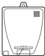
Sonará una alarma de fin de vida útil con el aviso "Beep Beep" cada 60 segundos. Una vez cada hora, la alarma emitirá el aviso "Beep Please Replace Detector" seguido de "Bip Bip Por favor, reemplace el detector". Al presionar el botón por 3 segundos, sonará una alarma con un aviso de "Beep Beep Please Replace Detector", seguido de "Bip Bip Por favor, reemplace el detector".
